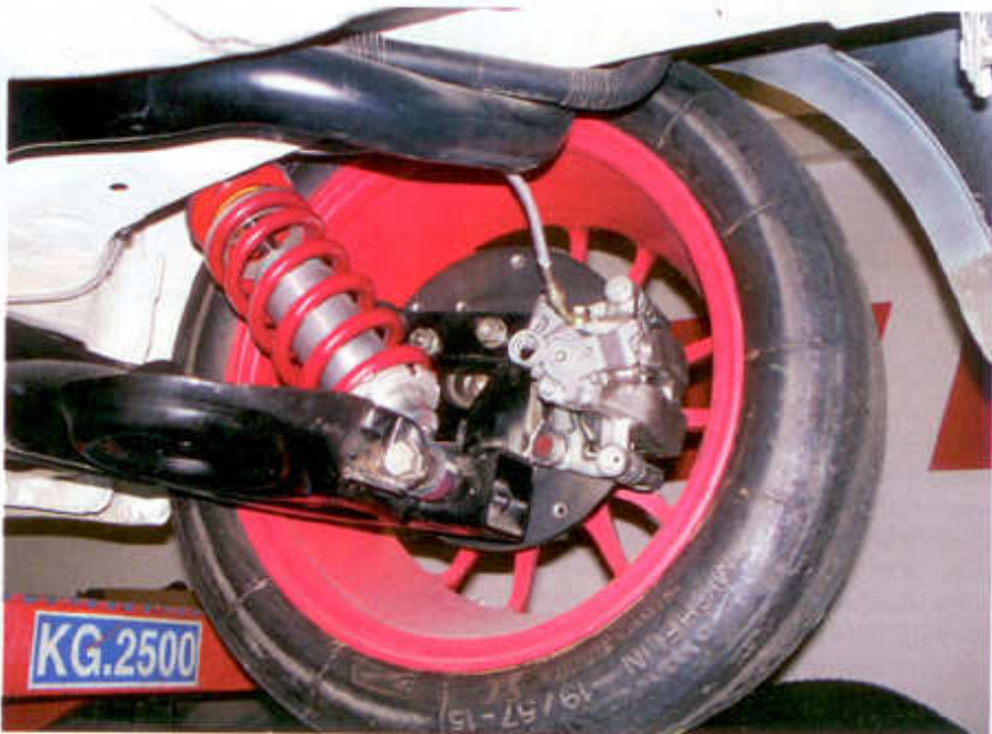
FIGURA 1 La molla non può arrestare efficacemente le oscillazioni della sospensione senza un ammortizzatore montato in parallelo. Quest'ultimo è un vero e proprio "freno" che dissipa l'energia e riporta rapidamente il sistema in "posizione di riposo". La taratura dell'ammortizzatore regola la velocità con cui si muove la sospensione, mentre l'ampiezza dell'escursione dipende dalla rigidità della molla.
